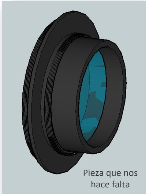
La pieza original que conecta la AO con el VISAC, que es a la que nos tendría que permitir enroscar el RF, tiene una rosca interior de un diámetro diferente a la rosca del RF. (48mm vs 54mm)
